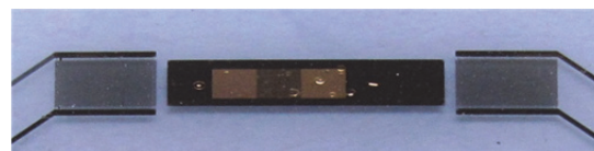
Microsenzor SAW cu substanta senzitiva configurata
